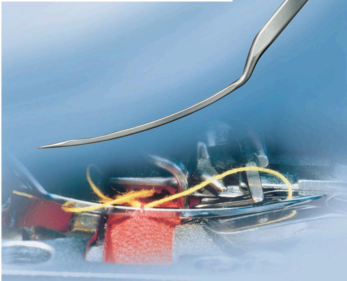
Производство снаружи невидимого, потайного шва зачастую очень проблематично. Решающим аспектом здесь является, чтобы игла на стороне закрепления столько волокон ткани проколола, сколько понадобится для надёжного закрепления нити. Проколы и пропуски шва не должны допускаться.
